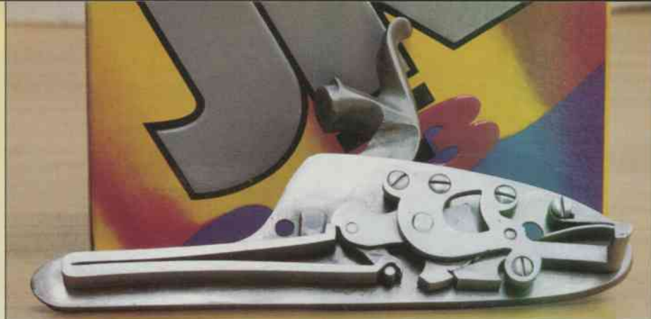
Sopra: gli acciarini, qui ancora in fase di costruzione, sono dotati di una robusta molla a lamina. Quando saranno terminati non mostreranno più tracce di lavorazione, grazie alla finitura manuale di tutti componenti.
