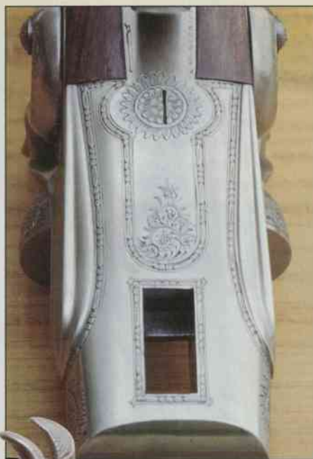
Sopra: gli acciarini, qui ancora in fase di costruzione, sono dotati di una robusta molla a lamina. Quando saranno terminati non mostreranno più tracce di lavorazione, grazie alla finitura manuale di tutti componenti.
